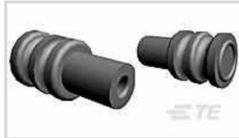
Dichtungstyp für Steckverbinder: **Einzeldrahtdichtung, Einzeldrahtdichtung**Durchmesser der Kontaktkammer: **3.6 mm [ .142 in ]**Durchmesser der Kabelisolierung zulässig: **1.4 mm [ .055 in ]**Dichtungsmaterial: **Silikon**Beständigkeit gegen Kohlenwasserstoffe: **SCHLECHT**
