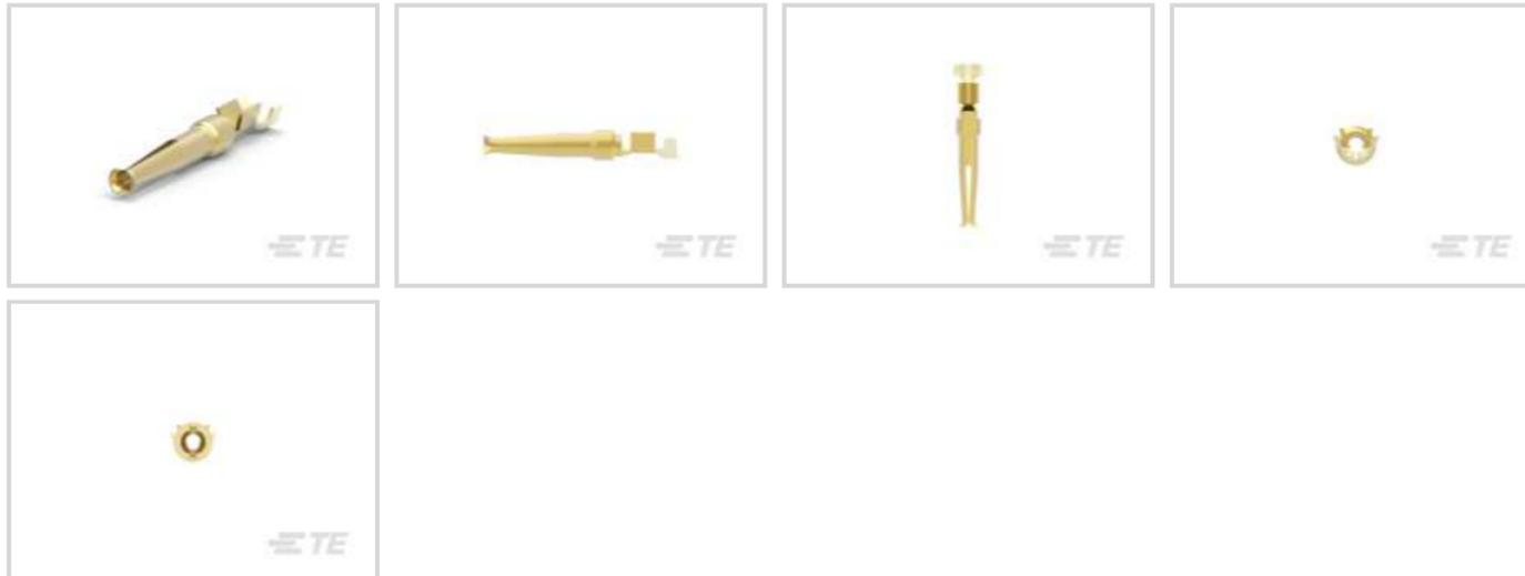
Kontakttyp: **Stecksockel**D-Sub-Kontaktgröße: **20**Kontaktmaterial: **Phosphorbronze**Beschichtungsmaterial des Steckbereichs des Kontakts: **Gold über Nickel**Anschlussmethode für Leitungen und Kabel: **Crimpverbindung**
