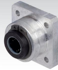
**Werkstoff:** Stranggepresstes Aluminiumgehäuse mit sauber gefräster Auflagefläche und präzisiertem Passungsdurchmesser. Mit einem geschlossenen Marken-Linearkugellager der ISO-Reihe 3 in hoher Qualität. Mit selbsttätigem Fluchtungsfehler-Ausgleich (Winkelausgleich) und Doppellippendichtungen.
