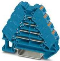
Rangierverteiler, Nennspannung: 250 V, Nennstrom: 10 A, Anschlussart: Push-in-Anschluss, 1., 2., 3. und 4. Etage, Bemessungsquerschnitt: 1,5 mm<sup>2</sup>, Querschnitt: 0,14 mm<sup>2</sup> - 2,5 mm<sup>2</sup>, Montage: NS 35/7,5, NS 35/15, Farbe: blau, Farbe Anschlusselemente: blau
