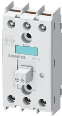
Halbleiterrelais, 3-phasig 3RF2 55 A / 40 °C 48-600 V / DC 4-30 V 2-Phasengesteuert Schraubanschluss Sperrspannung 1200 V
