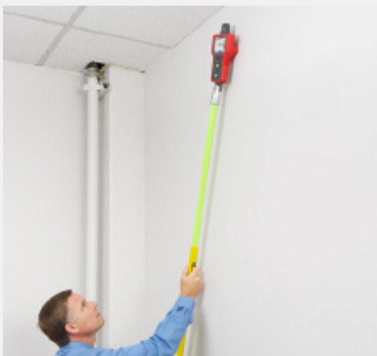
Aufspüren von Leitungen in schwer zugänglichen Bereichen mithilfe eines isolierten Verlängerungsstabs.
