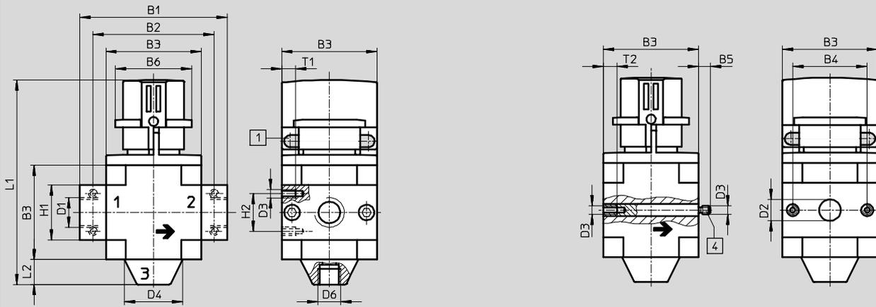
1 Bohrung zum Verschließen mit Bügelschloss
