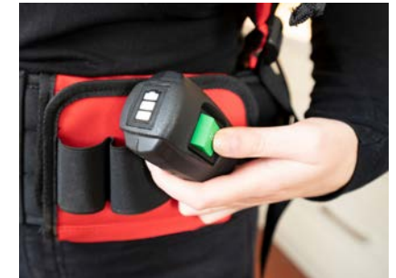
Ein-/Ausschalter mit Batterieanzeige
