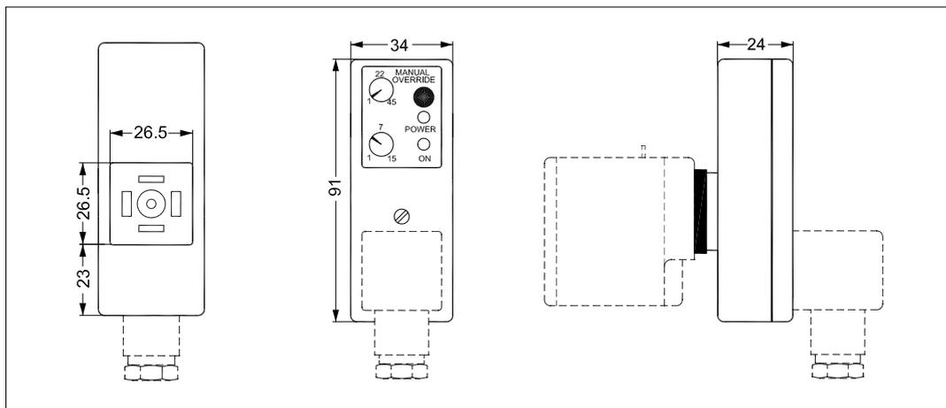
**Manuelle Übersteuerungseinheit, durch Gerät bedient**
