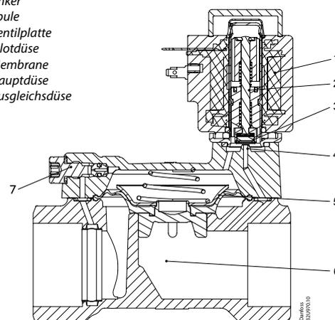
**Spulenspannung angeschlossen (unter Strom):**
