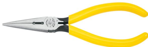
Diese Spitzzange mit Seitenschneider dient zur sauberen Abisolierung von 19-22 AWG-Leitern, die in Schaltschränken vorgefunden werden können. Die Schneidmesser sind induktionsgehärtet für Langlebigkeit. Sie besteht aus geschmiedetem Stahl für Langlebigkeit und verfügt über ein langes Maul zum Greifen und Verdrillen von Leitern.
