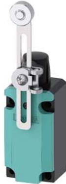
Positionsschalter Metallgehäuse 40 mm nach DIN EN 50041 Geräteanschluss 1x (M20 x 1,5) 1S/1Ö Sprungkontakte Schwenkantrieb rechts/links einstellbar mit längenverstellbarem Metallhebel 100 mm lang und Edelstahlrolle 19 mm
