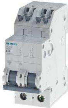
Leitungsschutzschalter 230V 6kA, 1+N-polig, B, 16A, T=70mm mit schraubenlosen Abgangsklemmen
