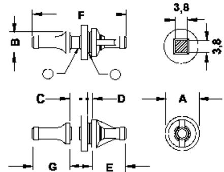
Lüfterseite / Fan Mounting: Bohrung / Hole:  $\varnothing$  4,5 mm
