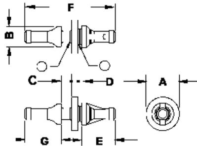
Lüfterseite / Fan Mounting: Bohrung / Hole:  $\varnothing$  4,5 mm
