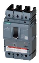
Leistungsschalter 3VA6 UL Frame 250 3-polig, Starterschutz ETU310M, I, In=200A ohne Überlastschutz Kurzschlussschutz Ii=3...12 x In ohne Anschluss
