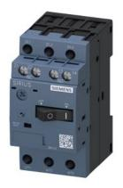
Leistungsschalter Baugröße S00 für den Motorschutz, CLASS 10 A-Auslöser 7...10 A N-Auslöser 130 A Schraubanschluss Standardschaltvermögen mit querliegendem Hilfsschalter 1S+1Ö
