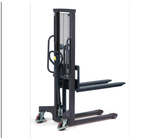
Für den gelegentlichen Einsatz als Hub- und Transportgerät. Stabile Profilstahl-Konstruktion mit Rohrschiebegriffen, pulverbeschichtet anthrazit RAL 7016. Hydraulikpumpe mit verchromten Kolben und Überlastventil. Betätigung über Zugdeichsel. Senkventil über Handhebel. 2 Lenkrollen, Räder Polyurethan-Bereifung 150 x 40 mm und 2 Gabelrollen Nylon 80 x 70 mm. Lenkrollen mit Feststeller. Lastschwerpunkt Abstand: 585 mm, Hub pro Deichselschlag 6855/6856: 20/12,5 mm, Gesamthöhe: 2010 mm
