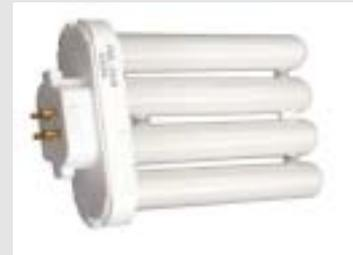
Energiesparlampe 4-Rohr 83x145mm Import Energiesparlampe 4-Rohr, mit Stecksockel GX10q, tageslicht, 6500K für konventionelle Vorschaltgeräte. Kompaktleuchtstofflampe FML 24W passend für Schreibtischleuchten. Ersatzleuchtmittel., Energieeffizienzklasse: B
