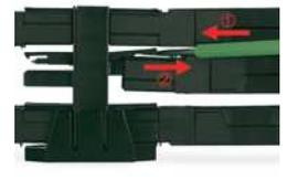
Alle Verbindungen am Verteiler sind direkt nach dem Stecken gegen unbeabsichtigtes Lösen verriegelt. Lösen der Verriegelung mittels Schraubendreher an allen Steckplätzen, auch bei voll belegtem Verteiler.
