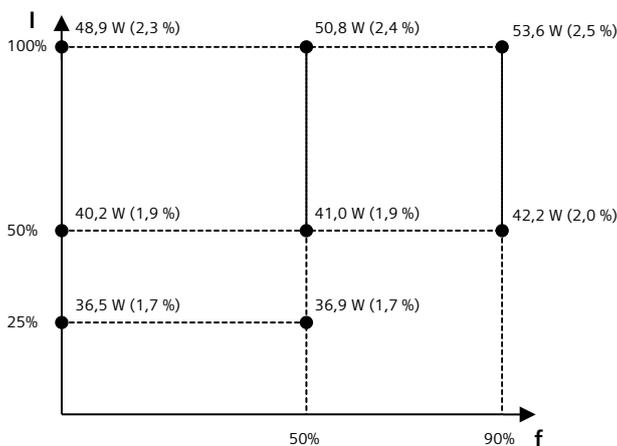
Die Prozentwerte geben die Verluste in Bezug auf die Bemessungsscheinleistung des Umrichters an.
