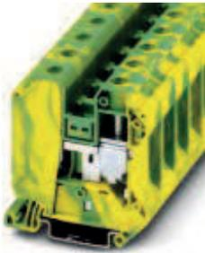
Morsetti comp. per conduttori terra, Collegamento: Connessione a vite, Sezione: 1,5 mm<sup>2</sup> - 35 mm<sup>2</sup>, AWG: 16 - 2, Larghezza: 16 mm, Altezza: 65,1 mm, Colore: giallo-verde, Tipo di montaggio: NS 35/7,5, NS 35/15
