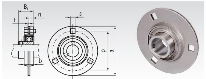
Bestellangaben: z.B.: Art.-Nr. 626 994 12, Kugel-Flanschlager SSBPF 201, Bohrung 12mm
