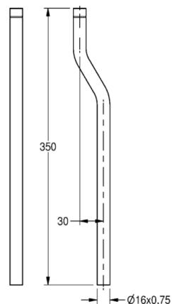
Spülrohrverlängerung mit O-Ring-Dichtung für Urinalspüler, Länge 350 mm, Kröpfung 30 mm, Messing poliert verchromt.
