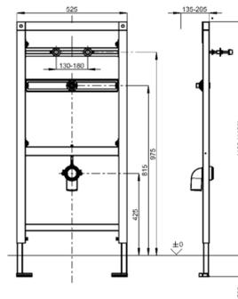
AQUAFIX-Installationselement für Edelstahl-Urinalbecken mit Siphonsteuerung, selbsttragende, pulverbeschichtete Stahlrahmenkonstruktion, TÜV geprüft, zur Einzelmontage für Trockenverkleidung, höhenverstellbare Objektbefestigung sowie Armaturenanschluss und Ablaufhalterung, vormontiert für Franke-Urinal CMPX538, schalldämmte Wanddurchführung G 1/2, Universalablaufbogen DN 50, Urinalbefestigungsbolzen, Bauschutz und Befestigungsmaterial.
