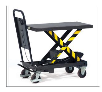
En acier soudé, revêtement époxy Gris Anthracite RAL 7016. Dossier de poussée fixe boulonné, pompe hydraulique à pédale. Vitesse de descente réglable. 2 roues fixes et 2 roues pivotantes à bandage en polyuréthane, moyeu à roulement à billes. Roues pivotantes avec freins.
