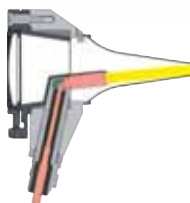
Direkte Beleuchtung mit Xenon Halogen Technologie
