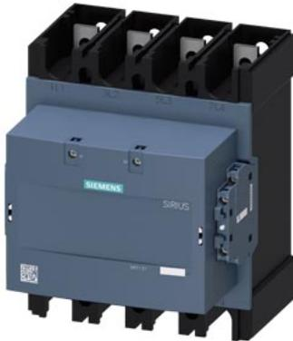
Schütz, AC-1, 500 A/400 V/40 °C, S12, 4-polig, AC 24-60V, DC 20-60V, 2S+2Ö, Anschlussschiene/ Schraubanschluss
