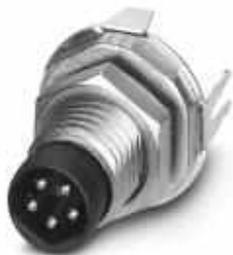
Sensor-/Aktor-Einbausteckverbinder, Stecker, 5-polig Device Net, M8, Hinterwand-/Schraubmontage mit M10-Befestigungsgewinde, mit geradem Lötanschluss
