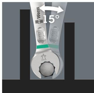
La chiave a forchetta e chiave poligonale Joker 6003, grazie alla sua speciale geometria, al lato a forchetta orientabile di 7,5° e alla geometria a doppio esagono, raddoppia le possibilità di impiego ruotando ripetutamente la chiave di 180° intorno all'asse longitudinale. Le teste delle viti e dei dadi possono essere orientate di 15° alla volta. Il Joker 6003 trova da solo, per così dire, il rispettivo punto di applicazione dopo ogni inversione.
