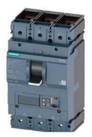
LEISTUNGSSCHALTER 3VA2 IEC FRAME 400 SCHALTVERMOEGENKLASSE H ICU=85KA @ 415 V 3-POLIG, ANLAGENSCHUTZ ETU850, LSI, IN=250A UEBERLASTSCHUTZ IR=100A ...250A KURZSCHLUSSSCHUTZ ISD=0,6..10X IN, II=1,5..12X IN N-LEITERSCHUTZ OPTIONAL MIT EXT. CT; BIS 160% SCHRAUBENFLACHANSCHLUSS
