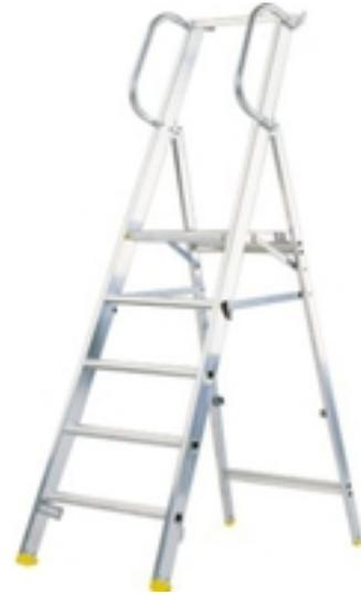
Material: Leichtmetall Geprüft nach Euronorm DIN EN 131 Stufentiefe: 85 mm Plattform (B/L): 440 x 400 mm 4 Stufen: Höhe: 1750 mm, Plattformhöhe: 950 mm , Gewicht: 9,5 kg 5 Stufen: Höhe: 2000 mm, Plattformhöhe: 1170 mm, Gewicht: 11 kg 6 Stufen: Höhe: 2200 mm, Plattformhöhe: 1400 mm, Gewicht: 12 kg 8 Stufen: Höhe: 2700 mm, Plattformhöhe: 1870 mm, Gewicht: 14 kg 10 Stufen: Höhe: 3150 mm, Plattformhöhe: 2330 mm, Gewicht: 16,5 kg 12 Stufen: Höhe: 3600 mm, Plattformhöhe: 2790 mm, Gewicht: 19 kg
