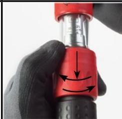
Um den Drehmoment-Schlüssel für Linksanzug zu verwenden, den Durchsteckvierkant von unten greifen und durch Drücken des Ver-/Entriegelungsknopfes den Durchsteckvierkant herausziehen und auf der gewünschten (anderen) Seite wieder hineinstecken. Auch hierbei den Ver-/Entriegelungsknopf drücken.
