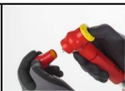
Um sicherzustellen, dass der vollständige Zusammenbau des Handwerkszeugs aus isolierten Werkzeugkomponenten von verschiedenen Herstellern Trennkräften standhält, wie sie während des vorgesehenen Gebrauchs erwartet werden, muss der Benutzer vor dem Gebrauch durch Ziehen mit der Hand in Trennrichtung feststellen, dass die Haltevorrichtungen aller verwendeten Teile wirksam sind.
