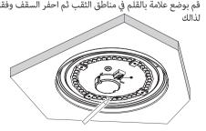
4. Drill expansion screw into the ceiling hole احفر مسمار التوسع في ثقب السقف
