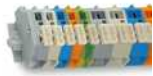
Klemmenleiste mit Befestigungsflanschen, für Schraub- u. ä. Befestigungsarten, Befestigungslöcher \varnothing 3,2 mm (mit Montagefuß (209-123) auch für Tragschiene 35)
