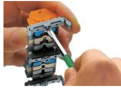
Klemmenleiste; mit Befestigungsflanschen, Anschrauben des Montagefußes (209-123) (Der Abstand der Montagefüße zueinander unter einer Klemmenleiste soll ca. 25 ... 30 mm betragen.)
