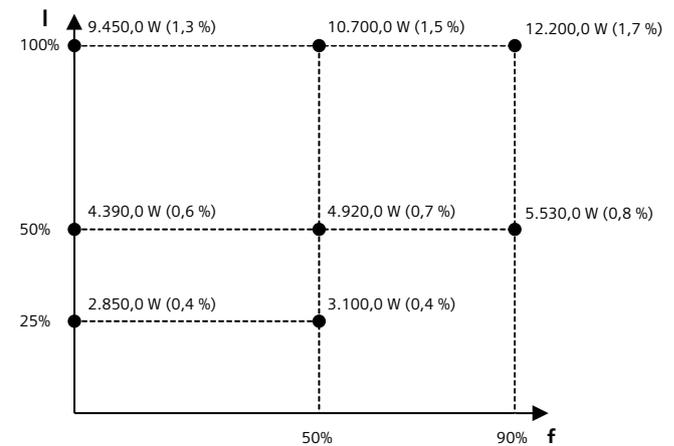
Die Prozentwerte geben die Verluste in Bezug auf die Bemessungsscheinleistung des Umrichters an.
