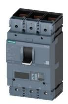
Leistungsschalter 3VA2 IEC Frame 630 Schaltvermögenklasse H Icu=85kA @ 415V 3-polig, Anlagenschutz ETU860, LSIG, In=400A Überlastschutz Ir=160A...400A Kurzschlussschutz Isd=0,6...10x In, Ii=1,5...15x In N-Leiterschutz optional mit externem Stromwandler, bis 160% Erdschlussschutz, abschaltbar Ig=0,2...1 x In, tg=0,05-0,8s Schraubenflachanschluss
