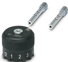
Lokator für Crimpzange RC-Z2514 und RC-Z2504, zur Vercrimpung gedrehter SF- und ST-Kontakte, Durchmesser 0,6 mm ... 1,0 mm und 2,0 mm.
