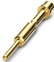
Crimpkontakt, Stift, gedreht, Einzelkontakt, Kontaktdurchmesser: 1 mm, Crimpbereich: 0,14 mm<sup>2</sup> ... 0,5 mm<sup>2</sup>, Alternativprodukt nach RoHS II ohne Ausnahme 6c (Pb < 0,1 %) Art.-Nr.: 1241921
