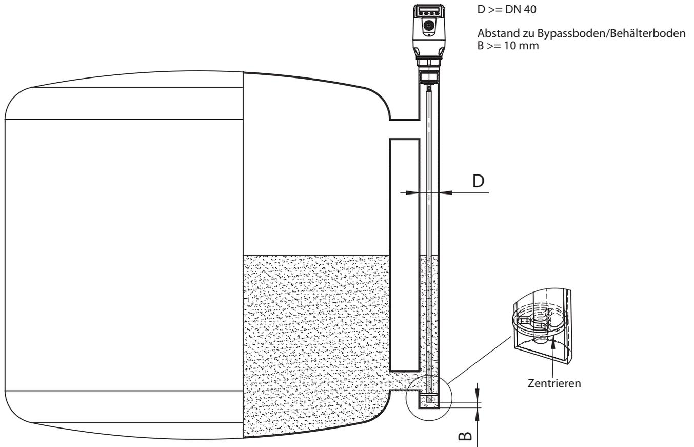
Einbau in einen metallischen Behälter
