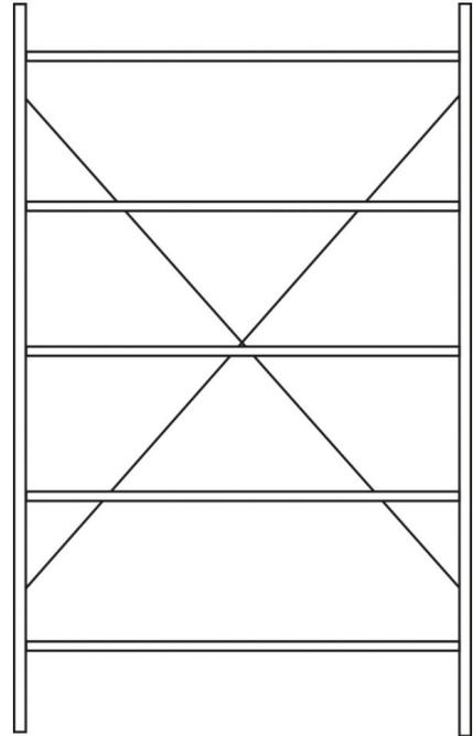
Das Regal ist 1345 mm (Grundfeld) bzw. 1315 mm (Anbaufeld) breit, 1960 mm, 2278 mm, 2490 mm oder 2967 mm hoch und wahlweise zwischen 300 bis 600 mm tief in einer extratiefen Variante sogar 800 mm.
