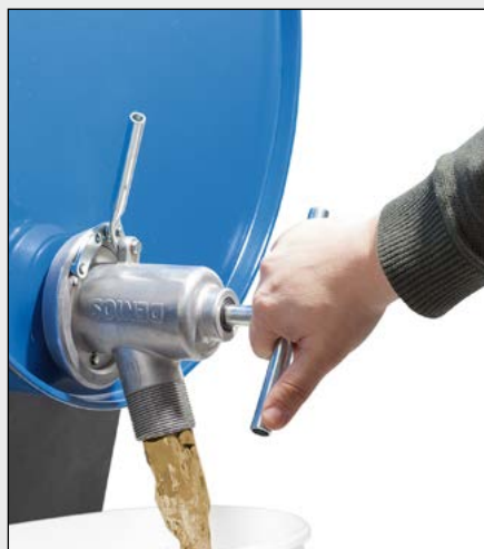
Durch Drehen des Handgriffes öffnen Sie das Spundloch und ziehen den Deckel nach vorne. So kann dann die Flüssigkeit auslaufen.
