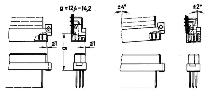
Um eine sichere Kontaktgabe zu gewährleisten und ein Beschädigen der Steckverbinder zu verhindern, sind nachfolgende Einbauhinweise zu beachten.
