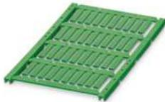
Leitermarker, Matte, grün, unbeschriftet, beschriftbar mit: TOPMARK NEO, TOPMARK LASER, BLUEMARK ID COLOR, BLUEMARK ID, BLUEMARK CLED, THERMOMARK PRIME, THERMOMARK CARD 2.0, THERMOMARK CARD, Montageart: einschieben, Kabeldurchmesserbereich: 0,6 ... 22 mm, Schriftfeldgröße: 18 x 4 mm, Anzahl der Einzelschilder: 40
