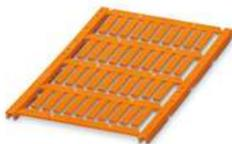
Leitermarker, Matte, orange, unbeschriftet, beschriftbar mit: TOPMARK NEO, TOPMARK LASER, BLUEMARK ID COLOR, BLUEMARK ID, BLUEMARK CLED, THERMOMARK PRIME, THERMOMARK CARD 2.0, THERMOMARK CARD, Montageart: einschieben, Kabeldurchmesserbereich: 0,6 ... 22 mm, Schriftfeldgröße: 18 x 4 mm, Anzahl der Einzelschilder: 40
