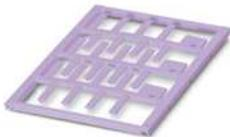
Kabelmarker, Matte, violett, unbeschriftet, beschriftbar mit: BLUEMARK ID COLOR, BLUEMARK ID, BLUEMARK CLED, PLOTMARK, CMS-P1-PLOTTER, Montageart: einschieben, Kabeldurchmesserbereich: 0,6 ... 22 mm, Schriftfeldgröße: 18 x 4 mm, Anzahl der Einzelschilder: 24
