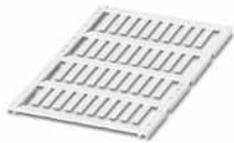
Leitermarker, Matte, weiß, unbeschriftet, beschriftbar mit: TOPMARK NEO, TOPMARK LASER, BLUEMARK ID COLOR, BLUEMARK ID, BLUEMARK CLED, THERMOMARK PRIME, THERMOMARK CARD 2.0, THERMOMARK CARD, Montageart: einschieben, Kabeldurchmesserbereich: 0,6 ... 22 mm, Schriftfeldgröße: 18 x 4 mm, Anzahl der Einzelschilder: 40
