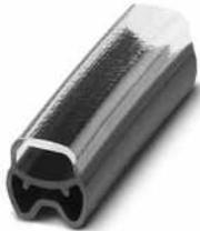
Ader-Bezeichnungsträger, transparent/schwarz, unbeschriftet, Montageart: aufschieben, Kabeldurchmesserbereich: 1,3 ... 2,8 mm, Schriftfeldgröße: 18 x 4 mm
