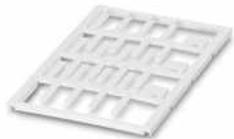
Kabelmarker, Matte, weiß, unbeschriftet, beschriftbar mit: BLUEMARK ID COLOR, BLUEMARK ID, BLUEMARK CLED, PLOTMARK, CMS-P1-PLOTTER, Montageart: einschieben, Kabeldurchmesserbereich: 0,6 ... 22 mm, Schriftfeldgröße: 18 x 4 mm, Anzahl der Einzelschilder: 24
