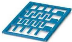
Kabelmarker, Matte, blau, unbeschriftet, beschriftbar mit: BLUEMARK ID COLOR, BLUEMARK ID, BLUEMARK CLED, PLOTMARK, CMS-P1-PLOTTER, Montageart: einschieben, Kabeldurchmesserbereich: 0,6 ... 22 mm, Schriftfeldgröße: 18 x 4 mm, Anzahl der Einzelschilder: 24
