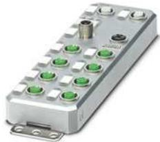
Axioline E, Digitaleingabegerät, PROFINET, M12-Schnellanschlusstechnik, Digitale Eingänge: 16, 24 V DC, Anschlusstechnik: 4-Leiter, Metallgehäuse, Schutzart: IP65/IP67
