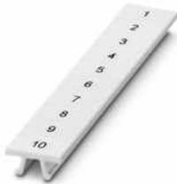
Zackband, Streifen, weiß, beschriftet, beschriftbar mit: CMS-P1-PLOTTER, quer bedruckt: fortlaufende Zahlen 1 ... 10, 11 ... 20 usw. bis 491 ... 500, Montageart: verrasten, für Klemmenbreite: 6,2 mm, Schriftfeldgröße: 6,15 x 10,5 mm, Anzahl der Einzelschilder: 10
