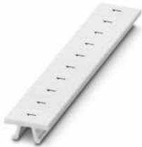
Zackband, Streifen, weiß, beschriftet, beschriftbar mit: CMS-P1-PLOTTER, längs bedruckt: gleiche Zahlen 1 oder 2 usw. bis 100, Montageart: verrasten, für Klemmenbreite: 6,2 mm, Schriftfeldgröße: 6,15 x 10,5 mm, Anzahl der Einzelschilder: 10
