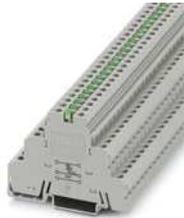
Initiatoren-/Aktorenklemme, Nennspannung: 250 V, Nennstrom: 24 A, Anschlussart: Schraubanschluss, 1., 2. und 3. Etage, Bemessungsquerschnitt: 2,5 mm<sup>2</sup>, Querschnitt: 0,2 mm<sup>2</sup> - 4 mm<sup>2</sup>, Montageart: NS 35/7,5, NS 35/15, Farbe: grau
