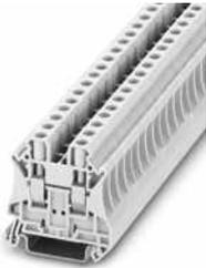
Durchgangsklemme, Nennspannung: 1000 V, Nennstrom: 41 A, Anschlussart: Schraubanschluss, Bemessungsquerschnitt: 6 mm<sup>2</sup>, Querschnitt: 0,2 mm<sup>2</sup> - 10 mm<sup>2</sup>, Montageart: NS 35/7,5, NS 35/15, Farbe: weiß
