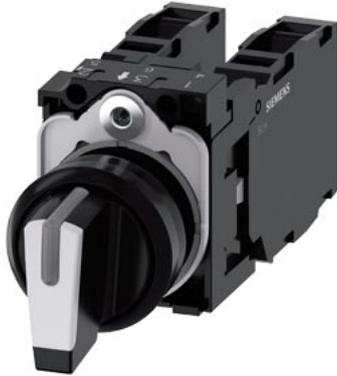
Knebelschalter, beleuchtbar, 22 mm, rund, Kunststoff, weiß, Knebel, kurz, 3 Schaltstellungen I>O<II, tastend, 10:30h/12h/13:30h, mit Halter, 2x1S+1Ö, Schraubanschluss
