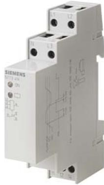
Spannungsrelais AC 230/400V 0,85 1 Wechslerkontakt Ansprechverzögerung 0,5 S Rückseitighaltverzögerung 60 S
