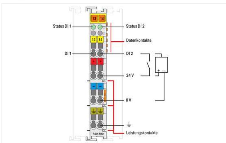
Das Digitaleingangsmodul erfasst Steuersignale aus dem Feldbereich, z.B. über Sensoren. Zur Störunterdrückung ist jedem Eingang ein Filter vorgeschaltet. Feld- und Systemebene sind galvanisch getrennt.
