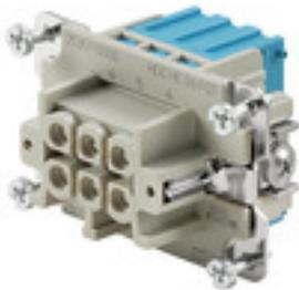
Bei dem Quick-Termination Anschluss ist die Leiteranschlussebene bereits geöffnet und der abisolierte Leiter kann einfach eingesteckt werden. In der Endposition schliesst der patentierte Klemmmechanismus automatisch. Dadurch ist sie praktisch wartungsfrei und es besteht eine sichere und dauerhafte Verbindung, welche rüttelfest ausgelegt ist. Weidmüller bietet somit als erster und einziger Hersteller diese neuartige Anschluss technik.
