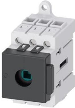
Lasttrennschalter 3LD3, Iu 25 A Hauptschalter 3-polig Bemessungsbetriebsleistung bei AC-23 A bei 400V 9,0kW Basisschalter ohne Knebelantrieb
