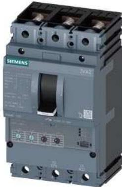
Leistungsschalter 3VA2 IEC Frame 100 Schaltvermögenklasse C Icu=110kA @ 415V 3-polig, Anlagenschutz ETU330, LIG, In=63A Überlastschutz Ir=25A...63A Kurzschlusschutz Ii=1,5...12 x In Erdschlussschutz Ig=0,25... 1 x In, tg=0,1/0,3s Schraubenflanschanschluss
